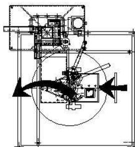
Elévateur de cuve modèle bas
