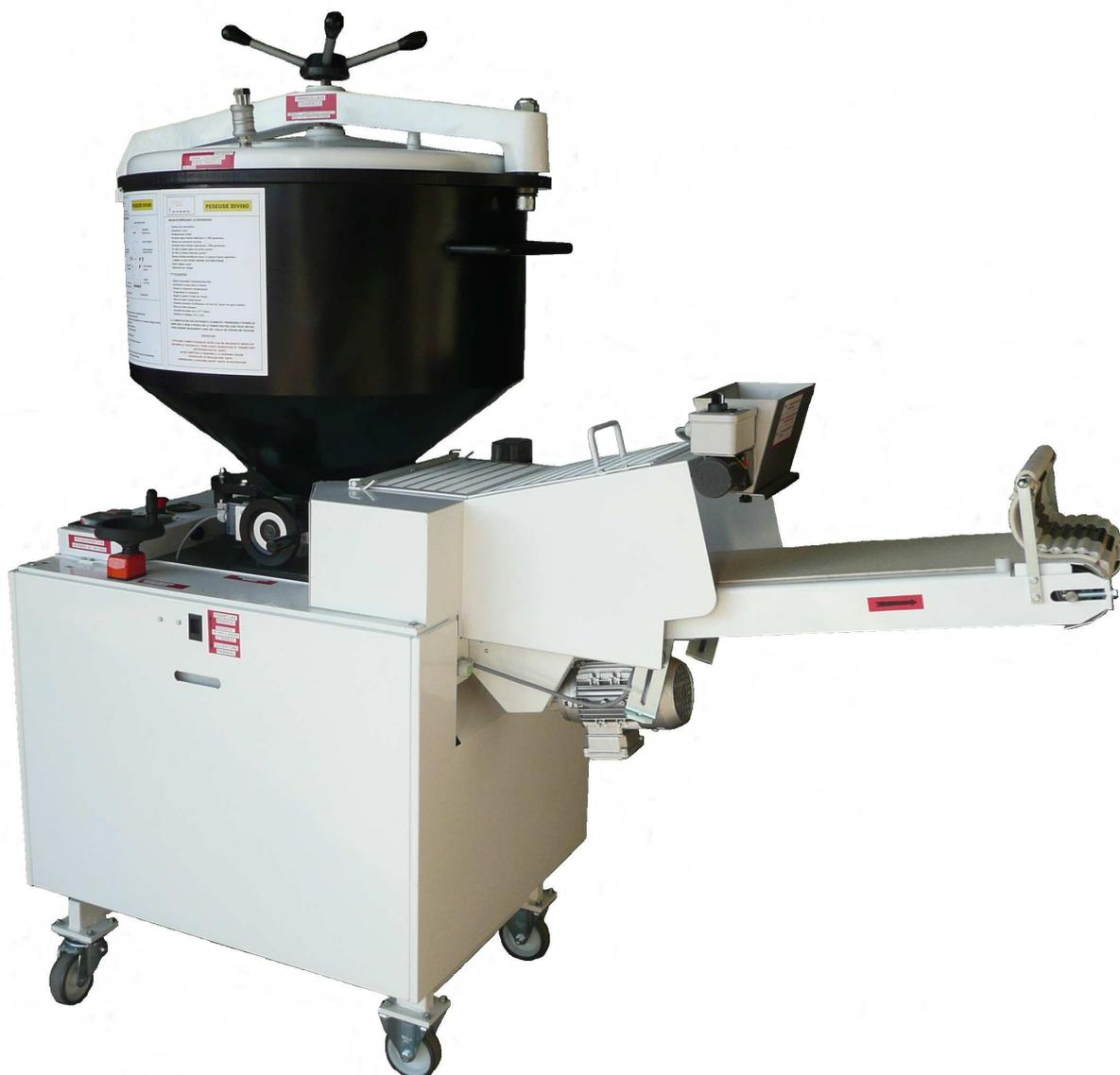
La peseuse diviseuse à trémie fermée est destinée à diviser la pâte en pâtons de poids égaux. Elle se différencie d'une diviseuse hydraulique par le fait que toute la masse de pâte dans le pétrin peut être déversée en une seule fois via un élévateur de cuve à la sortie du pétrin. De plus, elle dispose d'un tapis permettant d'alimenter une balancelle automatique, ou d'effectuer une reprise manuelle.
