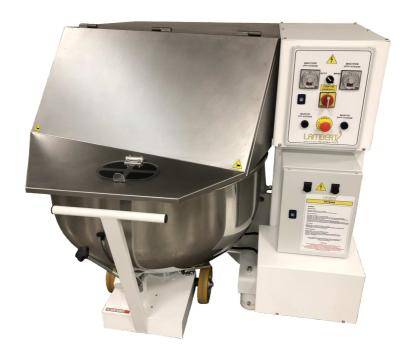
Les pétrins à cuve amovible sur chariot et à relevage hydraulique (fermeture et blocage de cuve hydraulique), permettent de transférer facilement la pâte obtenue vers un élévateur. Ils facilitent le repos en masse de la pâte dans la cuve, par enchaînement de pétrissage.
